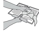
6. Setzen Sie das Zubehörteil wieder ein, indem Sie es hinten in die in der Abbildung dargestellten Aussparungen einführen und dann den Griff des Zubehörteils mit den Klammern oben verriegeln.
