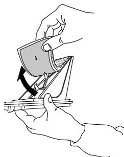
Fixez la mousse de filtre sur le filtre inférieur. Nettoyez la chambre du filtre de la sècheuse avec un chiffon humide ou minutieusement avec un aspirateur. Réinsérez le filtre inférieur. Refermez la poignée de filtre et fermez le volet inférieur.
