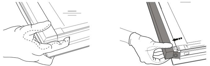
**3. Per riposizionare correttamente il vetro interno**, fare attenzione che la "R" sia leggibile nell'angolo destro e che la superficie lucida (non stampata) sia rivolta verso l'alto. Inserire dapprima il lato lungo del vetro indicato dalla "R" nelle sedi di sostegno, quindi abbassarlo in posizione.
