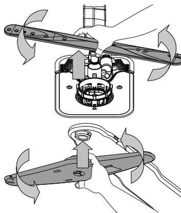
Den nedre spulearm kan tages af ved at trække den opad og dreje den mod uret. Den nedre spulearm sættes på igen ved at trække den nedad og dreje den med uret.
