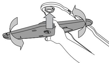
Górne ramię natryskowe można wyjmować wciskając je w górę i obracając je w kierunku przeciwnym do wskazówek zegara. Ponowne osadzenie ramienia natryskowego odbywa się poprzez pociągnięcie go w górę i obrócenie go w kierunku zgodnym z ruchem wskazówek zegara.
