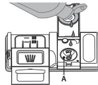
1. Stlačením a zatažením páčky na víku zásobník **B** otevřete.
