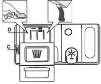
A mosogatószer-adagoló nyításához használja az **C** eszközt. A mosogatószer kizárólag a száraz **D** adagolóba önthető. Az előmosogatáshoz használt mosogatószert közvetlenül a mosogatóterbe helyezze.
