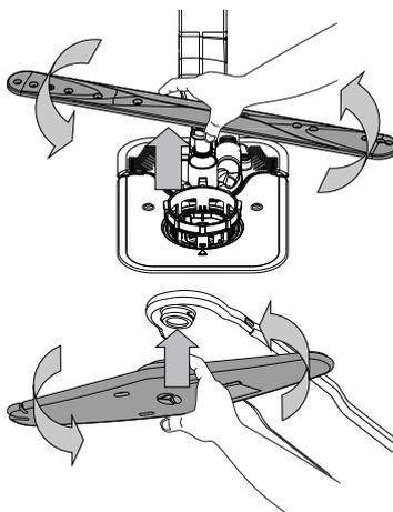
Spodné ostrekovacie rameno možno vybrať potiahnutím nahor a otočením proti smeru hodinových ručičiek. Znovu ho namontujete potiahnutím nadol a otočením v smere hodinových ručičiek.
