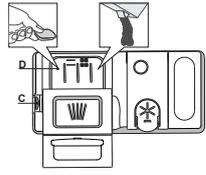
Per aprire il distributore detersivo utilizzare il dispositivo di apertura **C**. Versare il detersivo esclusivamente nel distributore **D** asciutto. Mettere la dose di detersivo per il prelavaggio direttamente all'interno del distributore.
