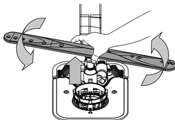
Dolne ramię natryskowe można wyjmować pociągając je w górę i obracając je w kierunku przeciwnym do wskazówek zegara. Ponowne osadzenie ramienia natryskowego odbywa się poprzez pociągnięcie go w dół i obrócenie go w kierunku zgodnym z ruchem wskazówek zegara.
