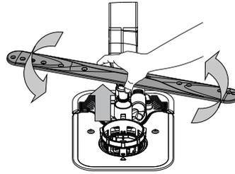
Alempi suihkuvarsi voidaan poistaa vetämällä sitä ylöspäin ja kiertämällä sitä vastapäivään. Suihkuvarsi asennetaan takaisin vetämällä sitä alaspäin ja kiertämällä myötäpäivään.
