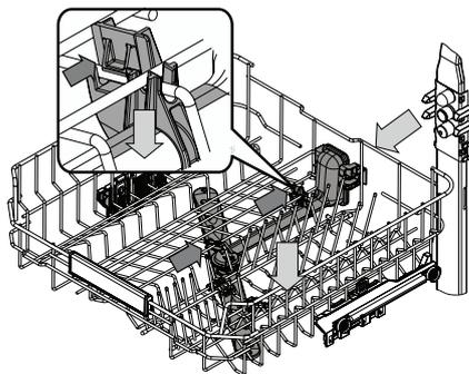
I noen tilfeller kan matrester sette seg fast på sprayarmer og blokkere hullene som vannet sprutes igjennom. Derfor bør du fra tid til annen kontrollere armene og gjøre de rene med en liten børste som ikke er av metall.
