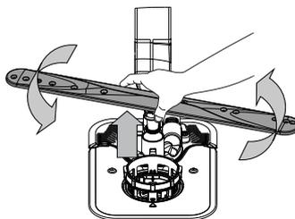
Den nedre spolarmen kan tas bort genom att dra den uppåt och vrida den moturs. Spolarmen monteras tillbaka genom att trycka den nedåt och vrida den medurs.
