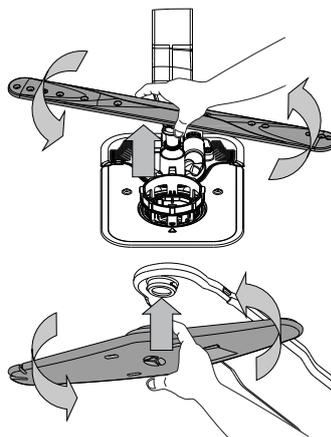
Il braccio di spruzzo inferiore può essere rimosso tirandolo verso l'alto e ruotandolo in senso antiorario. Il montaggio posteriore del braccio di spruzzo avviene tirandolo verso il basso e ruotandolo in senso orario.
