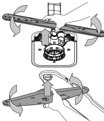
El brazo aspersor inferior se puede desmontar ejerciendo presión hacia arriba y girándolo a la izquierda. El montaje del brazo aspersor se realiza tirando de él hacia abajo y girándolo a la derecha.
