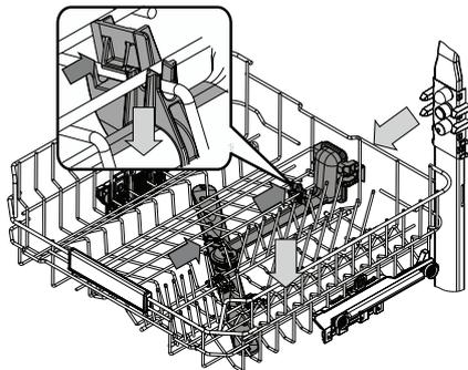
Der kan sidde madrester fast på spulearmene, som kan blokere de huller, vandet kommer ud af. Det anbefales derfor jævnligt at efterse spulearmene og rengøre dem med en lille ikke-metalholdig børste.
