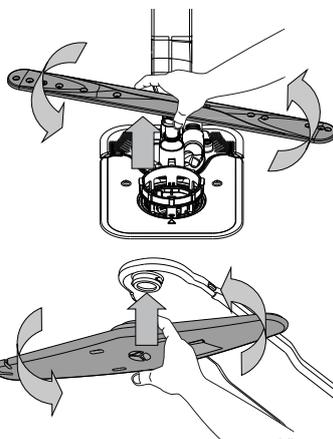
Az alsó szórókart felfelé húzva és az óramutató járásával ellentétes irányba elforgatva lehet kivenni a helyéről. A szórókart lefelé húzva és az óramutató járásával megegyező irányba elforgatva lehet visszaszerelni.
