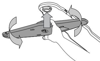
Horní ostríkovací rameno lze vyjmout zatlačením směrem nahoru a otočením proti směru hodinových ručiček. Zpětná montáž ostríkovacího ramene se provádí zatažením nahoru a otočením ve směru hodinových ručiček.
