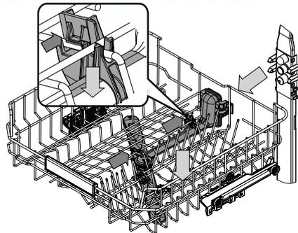
I vissa fall kan matrester fastna på spolarmarna och blockera hålen som vattnet spolas ut genom. Det rekommenderas därför att man kontrollerar spolarmarna lite då och då och rengör dem med en liten icke-metallisk borste.
