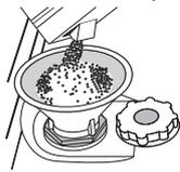
Dbajte, aby bol uzáver pevne zatiahnutý, aby sa počas umývacieho programu nedostal do zásobníka umývacieho prostriedku (mohlo by to nenapraviteľne poškodiť zmäkčovač vody). **Spustite program zakaždým hneď po doplnení zásobníka soli, aby ste sa vyhli korózii.**
