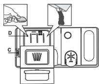
**K otevření zásobníku mycího prostředku použijte otevírací prvek C. Dávkujte mycí prostředek výhradně do suchého zásobníku D. Prostředek pro předmytí dávkujte přímo do prostoru myčky.**
