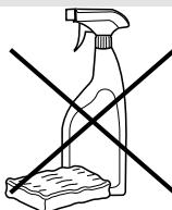
Les surfaces externes de l'appareil et le panneau de contrôle peuvent être nettoyés en utilisant un linge non abrasif humide. N'utilisez pas de solvants ou de produits abrasifs.
