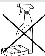
Le superfici esterne della macchina e il pannello comandi possono essere puliti mediante un panno in materiale non abrasivo preventivamente inumidito con acqua. Non utilizzare solventi o prodotti abrasivi.
