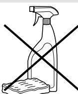
As superfícies externas da máquina e o painel de controlo podem ser limpos com um pano não abrasivo humedecido em água. Não utilize solventes ou produtos abrasivos.
