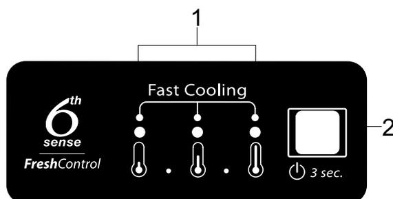
1. Indicadores luminosos (muestran el punto de ajuste actual de la temperatura o la función de Enfriamiento Rápido)
