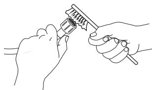
3. Løsne nå vanninntaksslangen på baksiden av vaskemaskinen for hånd. Bruk en tang og trekk ut nettfilteret fra ventilen på baksiden av vaskemaskinen og rengjør det nøyne.
