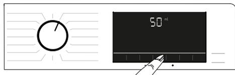
1. Pulse la tecla Dosificación automática. Cuando el detergente líquido está activado y el suavizante está desactivado, se activa la pantalla de ajuste de detergente líquido. Cuando el detergente líquido está apagado y el suavizante está encendido, se activa la pantalla de ajuste del detergente líquido. El LED de la pantalla de ajuste activo se enciende.
