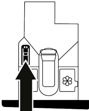
1. Presione sobre el elemento indicado por la flecha y tire del cajón de detergente hacia usted y retírelo.
