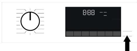
Si el nivel de agua de la lavadora no es adecuado al pulsar el botón de Inicio/Pausa, el bloqueo de la puerta no puede desactivarse y el símbolo de bloqueo de la puerta en la pantalla permanece encendido.
