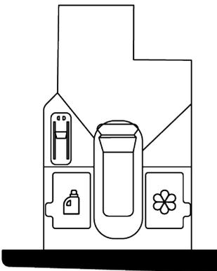
2. Para llenar el detergente líquido (izquierda) y el suavizante (derecha), abra la tapa del tanque respectivo hacia arriba como se muestra en la figura.
