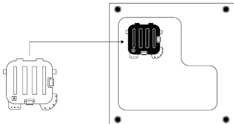
Incline la máquina ligeramente hacia atrás. Apoye las lengüetas de la cubierta A contra el panel inferior. Complete el montaje girando la tapa.
