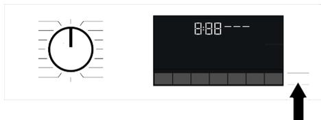
**i** Si la temperatura del agua en el interior de la máquina es superior a 50°C, no podrá desactivar el bloqueo de la puerta por razones de seguridad, aunque el nivel de agua sea el adecuado.
