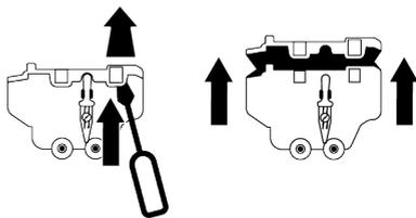
7. Retire las pestañas que sujetan la cubierta superior del cajón de detergente con un destornillador de punta plana (hay 6 pestañas en total, dos a la derecha, a la izquierda y en la parte posterior del cajón) y lave el interior del cajón.
