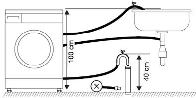
4. Para evitar que el agua residual vuelva a entrar en el aparato y para asegurar un fácil drenaje, no sumerja el extremo de la manguera en el agua residual o no la introduzca en el desagüe más de 15 cm. Si es demasiado larga, acórtela.
