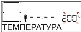
Коли на дисплеї блимає значення, натисніть кнопку  $+$  або  $-$ , щоб змінити його, а потім натисніть кнопку  $\checkmark$  для підтвердження. Після цього продовжуйте змінювати наступні налаштування (якщо це можливо).
