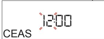
Apăsați pe + sau — pentru a seta ora corectă și apăsați pe ✓ : Cele două cifre care reprezintă minutele vor clipi pe afișaj. Apăsați pe + sau — pentru a seta minutele și apăsați pe ✓ pentru a confirma.
