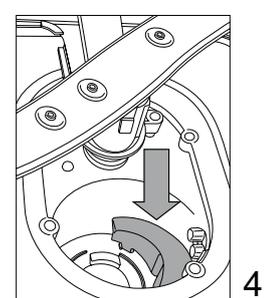
Depois de limpar os filtros, volte a colocar o conjunto de filtros e fixe-o corretamente na devida posição; isto é essencial para manter um funcionamento eficaz da máquina de lavar loiça.
