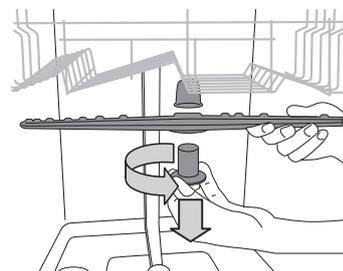
Para retirar o braço aspersor superior, rode o anel de bloqueio de plástico no sentido contrário ao dos ponteiros do relógio. O braço aspersor superior deve ser recolocado de modo a que o lado com mais orifícios fique voltado para cima.
