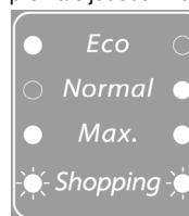
**Eko:** najmanje niska temperatura (uključeno lijevo svjetlo indikatora).
