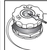
Vissez le bouchon. Éliminez les résidus de sel autour du bouchon. Certains réservoirs à sel possèdent un indicateur de niveau intégré dans le bouchon (reportez-vous à la méthode de contrôle ci-dessous).
