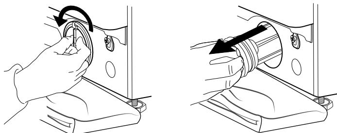
**5.** Očistite filter za vodu: uklonite ostatke u filtru i očistite ga tekućom vodom.
