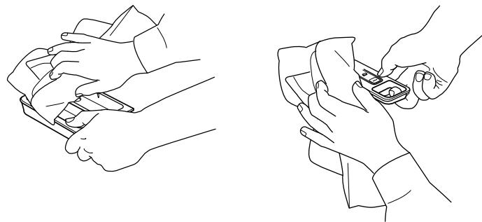
**2.** Uklonite umetak iz spremnika za deterdžent kao i umetak iz odjeljka za omekšivač.
