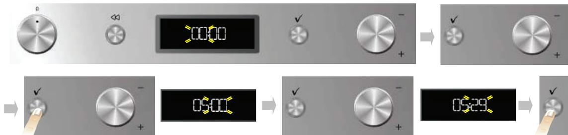
Après le réglage de la langue, il est nécessaire de régler l'heure. Les deux chiffres indiquant l'heure clignotent sur l'affichage.
