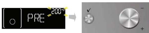
1. Tournez le bouton « Fonctions » jusqu'au symbole ⏩ pour sélectionner la fonction de préchauffage rapide.
