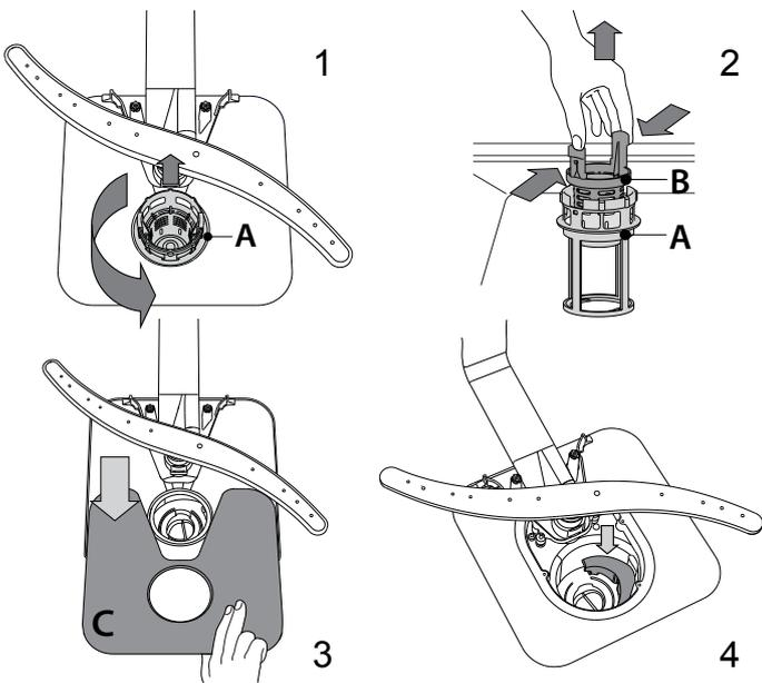
Setzen Sie die Filtereinheit nach der Reinigung der Filtersiebe wieder korrekt in ihren Sitz ein, dies ist äußerst wichtig, um eine ordnungsgemäße Betriebsweise des Geschirrspülers zu gewährleisten.
