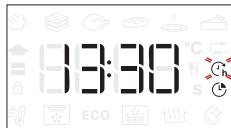
Vajadusel keerake nuppu, et määrata küpsetamise lõpuae, ning seejärel vajutage kinnitamiseks ja funktsiooni käivitamiseks .
