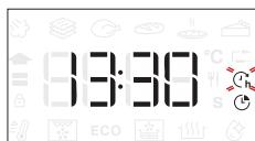
V prípade potreby otáčaním nastavovacieho ovládača nastavte želaný čas ukončenia pečenia, potvrďte stlačením a spusťte funkciu.
