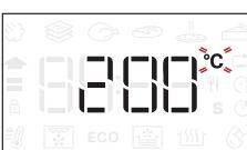
Jeżeli na ekranie miga ikonka °C, zmienić wartość za pomocą pokrętła, a następnie wcisnąć , aby zatwierdzić wybór i kontynuować zmianę ustawień kolejnych parametrów (o ile to możliwe).
