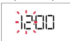
Začnú blikať dve číslice označujúce hodinu: Otočením gombíka nastavte hodinu a stlačením potvrďte.
