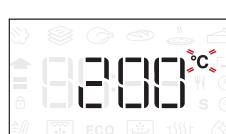
Ked' na displeji bliká ikonka °C, otáčaním gombíka zmeňte hodnotu, potvrďte stlačením a pokračujte zmenou ďalších nastavení (ak je to možné).
