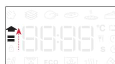
Po zakończeniu tej fazy zostanie wyemitowany sygnał dźwiękowy, a wyświetlacz wskaże, że piekarnik osiągnął ustawioną temperaturę.
