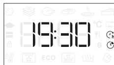
Lūdzu, nemiņiet vērā: iestatot aizkavētu gatavošanas sākuma laiku, tiks atspējota cepeškrāsns iepriekšējās uzsildīšanas fāze: krāsns pamazām sasniegus jūsu norādīto temperatūru, kas nozīmē, ka gatavošanas laiks būs ilgāks nekā norādīts gatavošanas tabulā.
