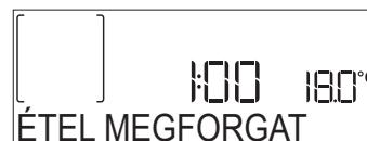
Hangjelzés hallatszik, és a kijelzőn látható a szükséges művelet. Nyissa ki az ajtót, hajtsa végre a kijelzőn látható műveletet, majd csukja be az ajtót, és nyomja meg a ▶ gombot a sütés folytatásához.
