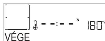
A sütés manuális (időzítés nélküli) üzemmódban történő folytatásához nyomja meg a ▶ gombot. Ha növelni kívánja a sütési időt, nyomja meg a + gombot az új időtartam megadásához. A sütési beállítások mindenkor változatlanok maradnak.
