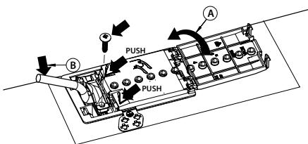
**Підключати прилад до джерела живлення потрібно за допомогою омніпольарного вимикача з мінімальним розривом контактів 3 мм.**
