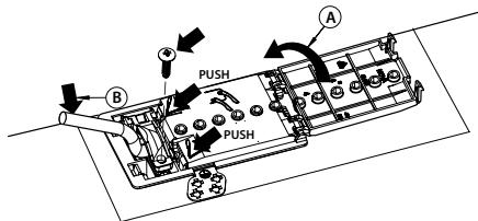
**Spotřebič musí být ke zdroji el. napájení připojen pomocí všepllového odpojovacího zařízení s minimální vzdáleností mezi kontakty 3 mm.**
