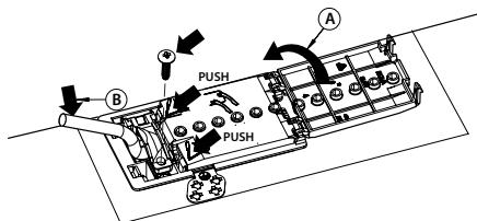
Napravo je treba priključiti na električno omrežje prek večpolnega ločilnega stikala z najmanj 3-milimetrskim razmikom med kontakti.
