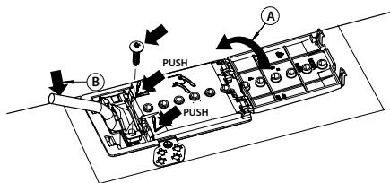
**Uređaj priključite na električno napajanje pomoću višepolnog prekidača za iskopčavanje s razmakom između kontakata najmanje 3 mm.**
