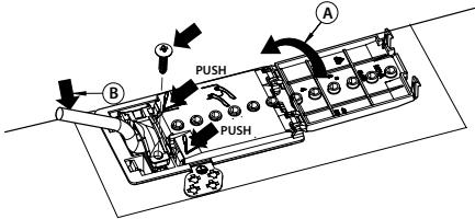
Η συσκευή πρέπει να συνδεθεί στην τροφοδοσία ρεύματος μέσω ενός πολυπολικού διακόπτη αποσύνδεσης με ελάχιστο διάστημα επαφής 3 mm.
