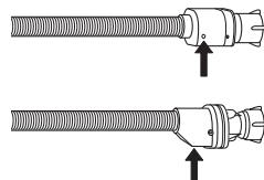
Caurules ūdens noplūdes apturēšanai: pārbaudiet nelielo drošības vārsta pārbaudes līdzziņu (skatiet bultīju). Ja tas ir sarkans, ūdens noplūdes apturēšanas funkcija ir aktivizēta un cauruli nepieciešams nomainīt pret jaunu. Lai atskrūvētu šo cauruli, tās atskrūvēšanas laikā nospiediet atbrīvošanas pogu (ja tāda pieejama).
