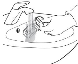
3. Ievietojiet atpakaļ filtru un uzstādīet vāciņu: ievietojiet atpakaļ ūdens filtru, griezot to pulkstena rādītāja virzienā. Pārliecinieties, ka tas tiek ievietots iespējamī dzīļi; filtra rokturim jābūt vertikālā pozīcijā. Lai pārbaudītu ūdens filtra hermētiskumu, varat ieliet aptuveni 1 litru ūdens mazgāšanas līdzekļa dozatorā. Tad uzstādīet vāciņu.
