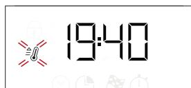
Remarque : Lors de la cuisson, vous pouvez changer la fonction en tournant le bouton de sélection ou ajuster la température en tournant le bouton du thermostat. La fonction ne démarre pas tant que le bouton du thermostat est sur la position **0 / AUTO**. Vous pouvez régler le temps de cuisson, le temps de fin de cuisson (seulement si vous réglez le temps de cuisson) et la minuterie.
