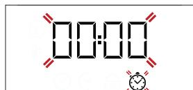
Utilisez + ou - pour régler l'heure désirée et appuyez sur ☰ pour confirmer. Un signal sonore se fait entendre lorsque la minuterie a terminé le compte à rebours.
