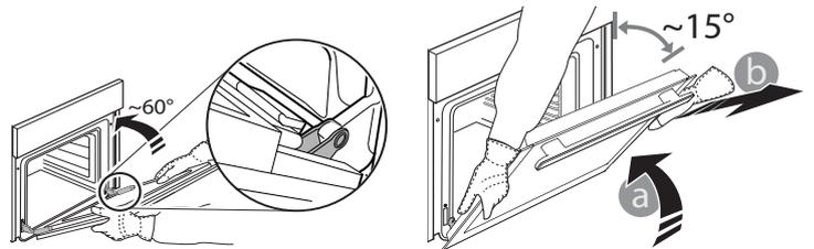
**3.** Per rimontare la porta, avvicinarla al forno allineando i ganci delle cerniere alle proprie sedi e ancorare la parte superiore agli alloggiamenti.
