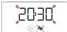
Utilizzare + o - per impostare l'ora in cui desidera terminare la cottura e premere ☰ per confermare. Attivare la funzione ruotando la *manopola termostato* in corrispondenza della temperatura desiderata o necessaria: la funzione resterà in pausa fino ad avviarsi automaticamente dopo un periodo di tempo calcolato per terminare la cottura all'orario impostato.
