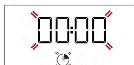
Za pomocą + lub - ustawić właściwy czas pieczenia i potwierdzić, wciskając . Włączyć tę funkcję, ustawiając pokrętło termostatu w pozycji wybranej temperatury: sygnał dźwiękowy i wskazanie na wyświetlaczu oznaczają, że pieczenie zostało zakończone.
