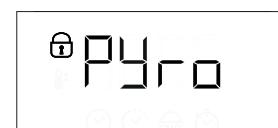
Po zakończeniu cyku drzwiczki pozostaną zamknięte do czasu, aż temperatura wewnętrz piekarnika powróci do bezpiecznego poziomu. W trakcie i po zakończeniu cyku czyszczenia piro należy przewietrzyć pomieszczenie.
