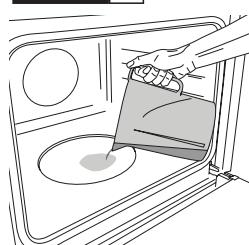
Per avviare la funzione Steam, versare 200 ml di acqua potabile sul fondo del forno. Selezionare la funzione ruotando in senso orario la manopola di selezione sull'icona corrispondente e la manopola del termostato in qualsiasi posizione tra 160 e 180°C (come suggerito dall'icona). La
