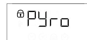
Odată cu finalizarea ciclului, ușa rămâne blocată până când temperatura din interiorul cuptorului revine la o valoare de siguranță. Aerisiti încăperea în timpul și la finalizarea derulării ciclului Pyro.
