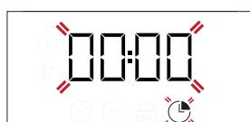
K nastavení času použijte + nebo - a provedte potvrzení stisknutím ☺ . Po ukončení odpočítávání zvoleného času samostatného časového spínače bude znít akustický signál.
