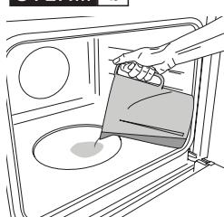
Pro spuštění funkce páry nalijte na dno trouby 200 ml pitné vody. Funkci zvolte otáčením ovladače výběru ve směru hodinových ručiček na příslušnou ikonu a ovladače termostatu do libovolné polohy mezi 160 a 180 °C (podle příslušné ikony). Funkce se spustí a na displeji se
