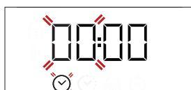
Izmantojiet + vai -, lai iestatītu stundas, un nospiediet ☺, lai apstiprinātu. Displejā mirgos divi cipari, kas apzīmē minūtes. Izmantojiet + vai -, lai iestatītu vēlamās minūtes, un nospiediet ☺, lai apstiprinātu.
