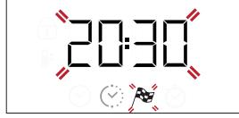
Utilice + o - para ajustar la hora de finalización de la cocción y pulse ☰ para confirmar.
