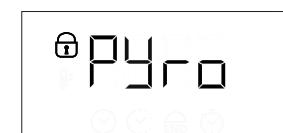
Після завершення циклу дверцята залишаються заблокованими, поки температура всередині духової шафи не повернеться до безпечної рівня. Провітрійте приміщення протягом циклу піролізного чищення та після його завершення.
