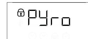
Ko se cikel zaključi, ostanejo vrata zaprta, dokler se temperatura v pečici ne vrne na varno raven. Med uporabo pirolitičnega čiščenja in po njem zračite prostor.
