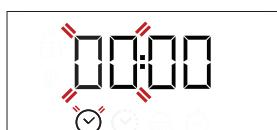
Utilizați + sau - pentru a seta ora și apăsați ☰ pentru a confirma. Cele două cifre aferente minutelor vor începe să clipească. Utilizați + sau - pentru a seta minutele și apăsați ☰ pentru a confirma.
