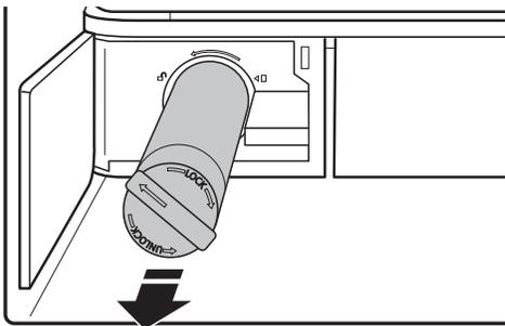
4. Entfernen Sie die Wasserfilterkappe von dem auszutauschenden Wasserfilter.
