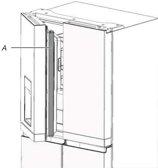
A. Dichtung mit Scharnier
