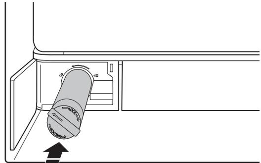
7. Fassen Sie den Wasserfilter und drehen Sie ihn um 90° nach rechts, bis er einrastet und die Pfeile korrekt ausgerichtet sind.
