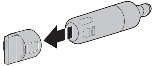
5. Setzen Sie die Wasserfilterkappe auf den neuen Filter. Stellen Sie sicher, dass die Pfeile so ausgerichtet sind, dass die Nuten im Filter auf die Rippen in der Filterkappe weisen.
