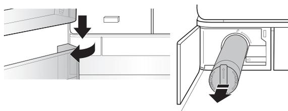
**HINWEIS:** Wenn der Filter nicht korrekt eingesetzt wird, dann wird das Wasser langsamer abgegeben, und die Eiswürfelproduktion verlangsamt sich ebenfalls. Eine falsche Filterinstallation kann auch zu einem Leck am Wasserfiltergehäuse führen.
