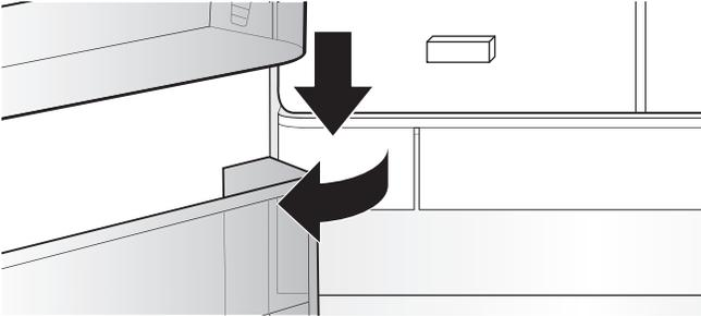
2. Drücken Sie den Wasserfilter zusammen und drehen Sie ihn um 90° nach links, damit er frei kommt.
