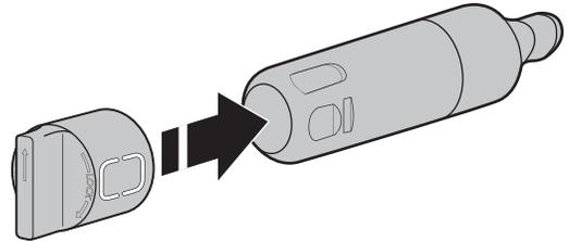
6. Setzen Sie den Filter in das Gehäuse ein.
