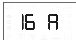
Sukdami pasirinkimo rankenėlę pasirinkite nominalią srovę, tada paspauskite ir patvirtinkite.
