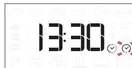
Vajadusel keerake nuppu, et määräta küpsetamise lõpuae, ning seejärel vajutage kinnitamiseks ja funktsiooni käivitamiseks .
