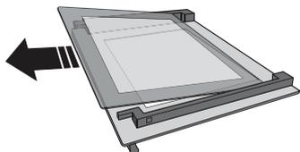
**3.** Встановіть проміжну панель (позначену «R») перед встановленням внутрішньої панелі: Щоб правильно встановити скляні панелі, переконайтеся, що маркування «R» можна побачити у лівому кутку. Спочатку вставте довгу сторону скла, позначену символом «R», в опорні гнізда, потім опустіть його у відповідне положення. Повторіть цю процедуру для обох скляних панелей.
