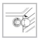
بعد فصل الفرن عن شبكة الكهرباء الرئيسية، أزل الغطاء الزجاجي الذي يغطي مقبس المصباح (أنظر الرسم).
