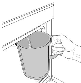
След като изберете функцията „Източване“, следвайте посочените действия: Отворете вратичката и поставете голяма кана под дупката за източване, намираща се в долната дясна част на панела. Щом започне източването, придържайте каната в позиция, докато действието не приключи.
