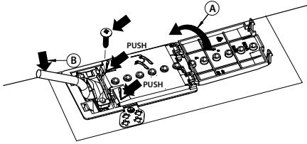
**Η συσκευή πρέπει να συνδεθεί στην τροφοδοσία ρεύματος μέσω πολυπολικού διακόπτη αποσύνδεσης με ελάχιστο διάστημα επαφής 3 mm.**
