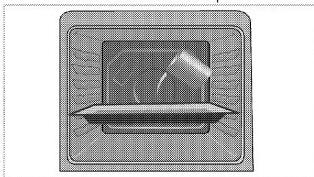
3. Impostare il forno in modalità facile pulizia con vapore e azionare a 100°C per 25 minuti.
