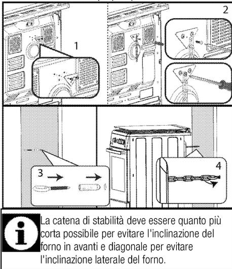
Catena di stabilità del piano cottura per piani cottura concepiti senza apertura per inserimento della staffa.
