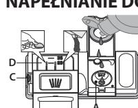
Płyń nabłyszczający ułatwia SUSZENIE naczyń. Dozownik płynu nabłyszczającego A powinien zostać napełniony, gdy kontrolka **BRAK PŁYNU NABŁYSZCZAJĄCEGO** świeci się na panelu sterowania.
