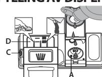
Skyllemiddel gjør at serviset TØRKER lettere. Dispenseren for skyllemiddel **A** bør etterfylles når indikatorlampen for **ETTERFYLING AV SKYLEMIDDEL** på kontrollpanelet lyser. Du må ALDRI tømme skyllemiddel direkte over i oppvaskmaskinen.
