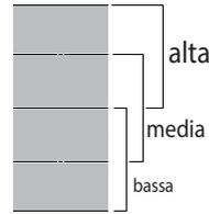
Divide la zona flessibile in tre zone di cottura (vedi figura) e le attiva ad una potenza predefinita (alta, media, bassa) in base alla posizione della pentola: spostando la pentola sulla superficie è possibile continuare la cottura a temperature diverse senza utilizzare i comandi.
