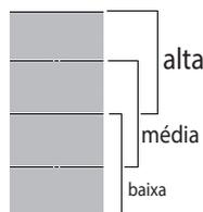
A zona flexível divide-se em três zonas de cozedura (ver figura) que são ativadas numa potência predefinida (alta, média ou baixa) dependendo da posição do tacho/panela: mova o tacho/panela sobre a superfície para continuar a cozedura a temperaturas diferentes sem ter de utilizar os controlos.
