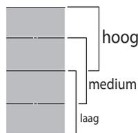
De flexibele zone is onderverdeeld in drie kookzones (zie de afbeelding) die ingeschakeld worden aan een vooraf ingesteld vermogen (hoog, medium of laag) afhankelijk van de positie van de (koken)pan: verplaats de (koken)pan over het oppervlak om de bereiding aan verschillende temperaturen uit te voeren zonder de bedieningen te hoeven gebruiken.
