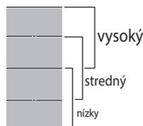
Flexibilná zóna je rozdelená na tri varné zóny (pozri obrázok) aktivované s prednastaveným výkonom (vysoký, stredný alebo nízky) v závislosti od polohy hrnca/panvice: posúvajte hrniec/panvicu po ploche, aby ste mohli ďalej variť pri rôznych teplotách bez použitia ovládačov.
