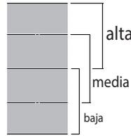
La zona flexible se divide en tres zonas de cocción (consulte la figura) que se activan a una potencia preconfigurada (alta, media o baja) en función de la posición de la olla/sartén: desplace la olla/sartén por la superficie para continuar cocinando a distintas temperaturas sin tener que usar los controles.
