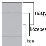
A rugalmas zóna három főzőzónából áll (lásd az ábrát), melyek az előre megadott teljesítménybeállításoknak (nagy, közepes vagy kicsi) megfelelően kapcsolnak be, az edény helyzetétől függően: mozgassa az edényt a felületre a főzés más hőmérsékleten történő folytatásához a kezelőelemek használata nélkül.
