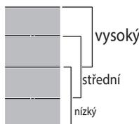
Flexibilní zóna je rozdělena do tří varných zón (viz obrázek), které pracují na přednastavený výkon (vysoký, střední či nízký) v závislosti na poloze hrnce/pánve: přesuňte hrnec/pánev po povrchu a pokračujte ve vaření při jiné teplotě, aniž byste museli používat ovládací prvky.
