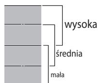
Strefa elastyczna podzielona jest na trzy strefy gotowania (patrz rysunek) aktywowane przy wcześniej ustalonej mocy (wysokiej, średniej lub niskiej) w zależności od położenia garnka/ patelni: przesunąć garnek/ patelnię po powierzchni, aby kontynuować gotowanie w różnych temperaturach bez konieczności używania elementów sterujących.
