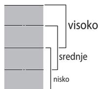
Fleksibilna zona je podeljena na tri zone kuvanja (vidite sliku) koje se aktiviraju pretpodešenom snagom (visoko, srednje ili nisko) u zavisnosti od položaja šerpe/tiganja: pomerite šerpu/tiganj preko površine da biste nastavili sa kuvanjem na drugoj temperaturi bez potrebe za korišćenjem kontrole.
