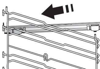
Ancorare alla griglia laterale la clip superiore della guida e farla scivolare fino a fine corsa. abbassare in posizione l'altra clip.
