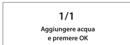
Disporre 200 ml d'acqua potabile sul fondo del forno e attivare la funzione a forno freddo. Premere
