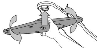
Der Deckensprüharm kann entfernt werden, diesen nach oben drücken und gegen den Uhrzeigersinn drehen. Der Sprüharm wird wieder eingebaut, indem er nach oben gezogen und im Uhrzeigersinn gedreht wird..
