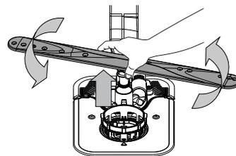
Um den unteren Sprüharm abzuhängen, diesen nach oben ziehen und gegen den Uhrzeigersinn drehen. Der Sprüharm wird wieder eingebaut, indem er nach unten gezogen und im Uhrzeigersinn gedreht wird.
