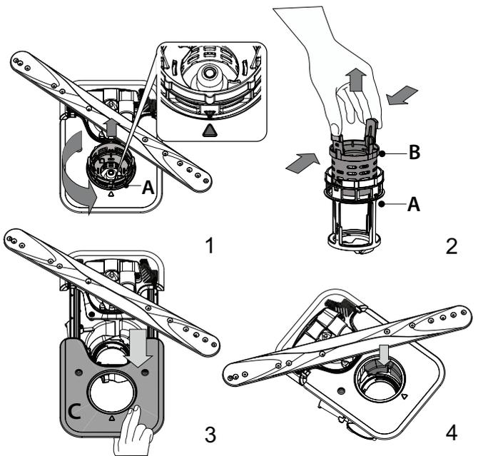
Setzen Sie die Filtereinheit nach der Reinigung der Filtersiebe wieder korrekt in ihren Sitz ein, dies ist äußerst wichtig, um eine ordnungsgemäße Betriebsweise des Geschirrspülers zu gewährleisten.
