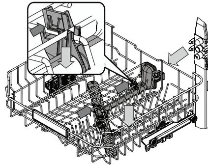
Es kann vorkommen, dass Speisereste an den Sprüharmen hängen bleiben und die Wasserdüsen verstopfen. Prüfen Sie die Sprüharme daher regelmäßig und reinigen Sie sie bei Bedarf mit einer Kunststoffbürste. Zum Entfernen des oberen Sprüharms müssen sie diesen zusammen mit dem Anschlussstück entfernen.
