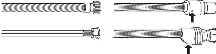
Wenn der Zulaufschlauch eine transparente Beschichtung hat, regelmäßig prüfen, ob die Farbe sich örtlich verstärkt. Wenn ja, könnte der Schlauch eine undichte Stelle haben und muss ausgetauscht werden.
