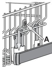
Der Oberkorb ist mit einem **Oberkorb Höhenversteller** (siehe Abbildung) ausgestattet. Ohne Drücken der Hebel kann er einfach durch Heben der Korbseiten angehoben werden, sobald der Korb stabil in seiner unteren Stellung ist.
