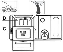
Zum Öffnen des Spülmittelbehälters den Öffnungsmechanismus C drücken. Füllen Sie das Spülmittel ausschließlich in das trockene Fach D ein. Die für den Vorspülgang benötigte Spülmittelmenge wird direkt in den Geschirrspüler gegeben.
