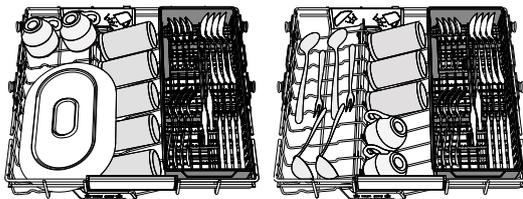
Eine getrennte Anordnung des Bestecks macht das Sortieren nach dem Spülen einfacher und verbessert die Spül- und Trockenleistung.
