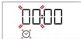
Utilizați + sau - pentru a seta ora și apăsați pentru a confirma. Cele două cifre aferente minutelor vor începe să clipească. Utilizați + sau - pentru a seta minutele și apăsați pentru a confirma.
