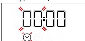
Izmantojiet + vai -, lai iestatītu stundas, un nospiediet , lai apstiprinātu. Displejā mirgos divi cipari, kas apzīmē minūtes. Izmantojiet + vai -, lai iestatītu vēlamās minūtes, un nospiediet , lai apstiprinātu.
