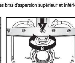
Insérez et serrez à fond les bras d'aspersion supérieur et inférieur.
