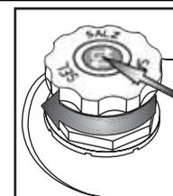
Vissez le bouchon. Éliminez les résidus de sel autour du bouchon. Certains réservoirs à sel ont un indicateur de niveau intégré dans le bouchon (voir la méthode de contrôle ci-dessous).
