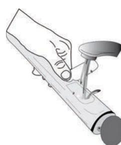
Välj funktionen "Töm" med vattenlådan ordentligt insatt i ugnen. Tryck sedan på  och vänta tills programmet startar automatiskt. Den genomsnittliga tidslängden för en fullständig tömning är cirka en minut. Därefter kan lådan tas bort och tömmas.
