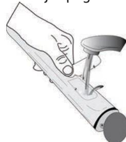
Tinkamai ištumë vandens stalčiuką į orkaitę, pasirinkite funkciją „Išleisti“, paspauskite ☐ ir palaukite, kol ciklas bus atliktas automatiškai. Vidutinė viso išleidimo trukmë yra apie viena minutę. Po to stalčių galima ištraukiti ir ištuštinti.
