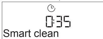
Pritisnite □ za vklop funkcije: zaslon vas bo pozval, da izvedete vsa dejanja, potrebna za najboljše rezultate čiščenja: sledite navodilom in na koncu pritisnite ✓. Potem ko opravite vse korake in ko aparat to od vas zahteva, pritisnite □ za začetek cikla čiščenja.
