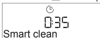
Stisknutím ▶ se funkce aktivuje: Displej vás bude informovat o všech krocích, které je třeba provést, aby bylo dosaženo co nejlepšího výsledku čištění: Řídte se těmito pokyny a po jejich dokončení stiskněte ✓ . Po provedení všech kroků spusťte cyklus čištění stisknutím tlačítka ▶ .
