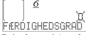
Tryk, på anmodning, på + eller - for at vælge det ønskede niveau mellem rødstegt (-1) og gennemstegt (+1). Tryk på ✓ eller ▶ for at bekræfte og starte funktionen.
