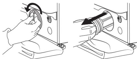
5. Limpie el filtro del agua: elimine los residuos del filtro y lávelo bajo el agua corriente.
