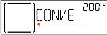
Para seleccionar un elemento del menú (la pantalla mostrará el primer elemento disponible), gire el *selector de ajuste* hasta que se visualice el elemento que desea.
