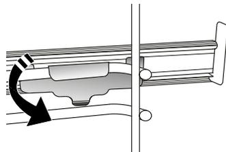
Nota: Las guías deslizantes se pueden montar en cualquier nivel.
