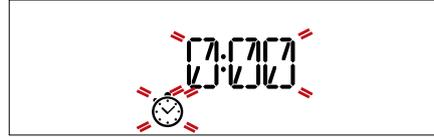
Nota: El temporizador no activa ninguno de los ciclos de cocción. Utilice el *selector de ajuste* para cambiar el tiempo ajustado en el temporizador; para apagar el temporizador en cualquier momento, gire el *selector* a 0.
