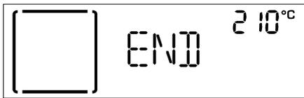
Pulse el *botón de selección/confirmación* para continuar la cocción con el modo manual (sin tiempo de cocción programado) o gire el *selector de ajuste* para alargar el tiempo de cocción configurando una nueva duración. En ambos casos, la temperatura o la configuración de nivel del grill se mantendrán.
