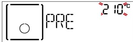
В момент ее завершения подается звуковой сигнал и на дисплее возникает сообщение о том, что духовка достигла заданной температуры. Откройте дверцу, поместите продукт в духовку и закройте дверцу, чтобы начать процесс приготовления. После окончания прогрева духовка автоматически выбирает обычный режим. При необходимости выберите другой режим приготовления, вращая *ручку выбора режимов*.
