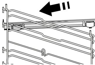
Закрепите верхний зажим направляющей на держателе полок и сдвиньте ее вглубь до упора. Опустите второй зажим в предусмотренное положение.
