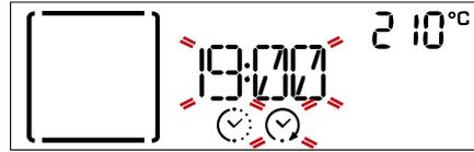
Gire el *selector de ajuste* para configurar la hora en la que quiere que termine la cocción y pulse el *botón de selección/confirmación* para confirmar e iniciar la función.
