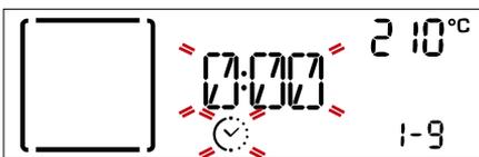
Cuando parpadee el icono ⌚ en la pantalla, utilice el *selector de ajuste* para ajustar el tiempo de cocción necesario y luego pulse el *botón de selección/confirmación* para confirmar.
