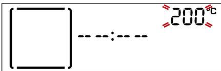
Cuando el valor parpadee en la pantalla. Gire el *selector de ajuste* para cambiarlo, pulse el *botón de selección/confirmación* para confirmar y siga modificando la configuración siguiente (si es posible).
