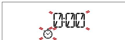
Примечание: Таймер не запускает какие-либо режимы приготовления. Для изменения заданного времени таймера используйте *ручку регулировки*. Поверните *ручку выбора* на 0, чтобы выключить таймер в любой момент времени.
