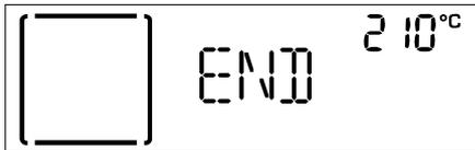
Premere il *tasto di selezione/conferma* per continuare la cottura in modalità manuale (senza una durata impostata) o ruotare la *manopola di regolazione* per prolungare la cottura impostando una nuova durata. In entrambi i casi, i valori della temperatura o del livello del grill saranno mantenuti in memoria.
