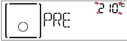
Cuando el precalentamiento haya terminado, sonará una señal acústica y la pantalla indicará que el horno ha alcanzado la temperatura establecida. En este momento, abra la puerta, coloque los alimentos en el horno y cierre para iniciar la cocción. Al completarse la fase de precalentamiento, el horno selecciona automáticamente la función convencional: Para ajustar una función de cocción distinta, gire el *selector* y seleccione la función deseada.
