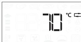
Premeu per iniciar els ajustaments. Feu servir **+** i el botó **-** per ajustar la temperatura objectiu per la sonda de carn. Premeu per confirmar.
