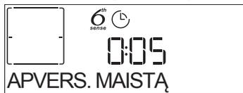
Pasigirs garso signalas, o ekrane bus rodoma, koks veiksmas turi būti atliktas. Atidarykite dureles, atlikite ekrane nurodytą veiksmą ir uždarykite dureles, kad gaminimas būtų tęsiamas.
