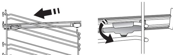
Vă rugăm să rețineți următoarele: Șinele culisante pot fi montate pe orice nivel.
