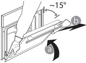
3. Įstatydami dureles pastumkite jas link orkaitės, sulygiuokite vyrių kabliukus tvirtinimo vietose ir užfiksuodami viršutinę dalį.
