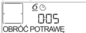
Urządzenie wyda sygnał dźwiękowy, a na wyświetlaczu pojawi się wskazówka mówiąca o konieczności wykonania czynności. Otworzyć drzwiczki, wykonać czynność wskazaną na wyświetlaczu i zamknąć drzwiczki, po czym kontynuować gotowanie.
