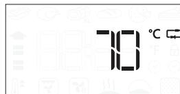
Stlačením spustíte nastavenia. Cieľovú teplotu mäsovej sondy nastavíte tlačidlami + a - . Stlačením potvrdte.
