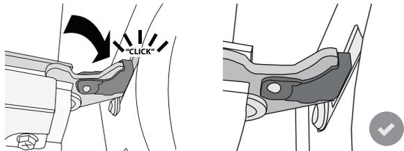
5. Încercați să închideți ușa și asigurați-vă că se aliniază cu panoul de comandă. În caz contrar, repetați pașii de mai sus: Ușa s-ar putea deteriora dacă nu funcționează corespunzător.
