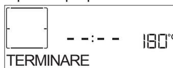
Apăsați pe pentru a continua procesul de preparare în modul manual (necronometrat) sau apăsați pe + pentru a prelungi durata de preparare setând o durată nouă. În ambele cazuri, parametrii de preparare vor fi memorați. Odată ce alimentele au fost scoase, lăsați cuptorul să se răcească cu ușa închisă.
