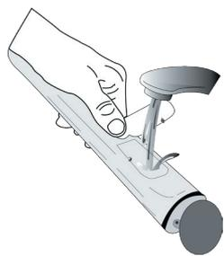
Wybrać funkcję "Opróżnianie" przy szufladzie na wodę prawidłowo włożonej do piekarnika, nacisnąć i poczekać na automatyczne uruchomienie cyklu. Średni czas trwania opróżniania przy pełnym obciążeniu wynosi około jednej minuty. Po zakończeniu szufladę można wyjąć i opróżnić.
