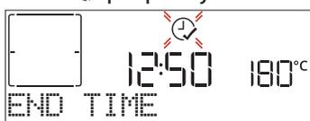
Feu servir + o - per ajustar l'hora de finalització de cocció desitjada i premeu ✓ per confirmar i activar la funció. Introduïu el menjar al forn i tanqueu la porta: Un cop finalitzat el temps calculat, la funció s'iniciarà automàticament per tal que la cocció finalitzi a l'hora desitjada.
