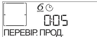
Пролунає звуковий сигнал і на дисплеї відобразиться дія, яку потрібно виконати. Перевірте страву, зачиніть дверцята та продовжіть готування.
