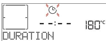
Quan la icona ⌚ parpelleja a la pantalla, feu servir + o - per ajustar el temps de cocció desitjat i premeu ✓ per confirmar. Si voleu gestionar la cocció de forma manual, no haureu d'ajustar el temps de cocció (no temporitzat): Premeu ✓ o ▶ per confirmar i iniciar la funció. Si seleccioneu aquest mode, no podreu programar un inici diferit.
