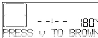
Quan la pantalla mostri el missatge corresponent, si és necessari premeu  $\checkmark$  per iniciar un cicle d'enrossiment de cinc minuts. Podeu aturar la funció en qualsevol moment prement per apagar el forn.
