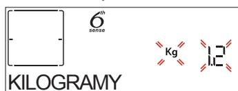
Aby prawidłowo ustawić tę funkcję, postępować zgodnie ze wskazówkami na wyświetlaczu: po wyświetleniu nakazu, nacisnąć przycisk + lub -, aby ustawić żadaną wartość, a następnie nacisnąć przycisk ✓, aby potwierdzić.
