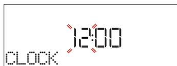
Feu servir + o — per configurar l'hora correcta i premeu ✓: els dos dígit dels minuts parpellejaran a la pantalla. Feu servir + o — per configurar els minuts i premeu ✓ per confirmar.
