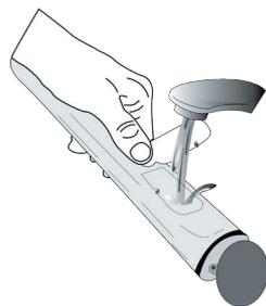
Seleccioneu la funció «Drain» (Drenatge) amb el calaix d'aigua ben inserit al forn, premeu  $\rightarrow$  i espereu que el cycle s'executi automàticament. La durada mitjana per al drenatge de càrrega completa és d'aproximadament un minut. Un cop fet, el calaix es pot extreure i buidar.
