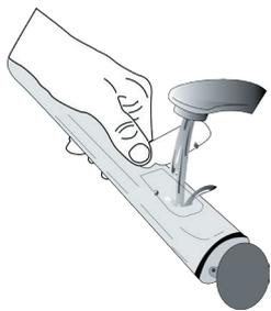
Pasirinkite funkciją „Drain“ (išleisti), vandens stalčių tinkamai įkišę į orkaitę, paspauskite
