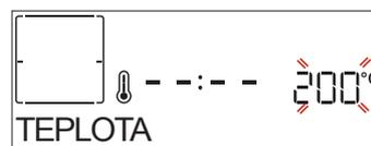
Keď na displeji bliká hodnota, pomocou **+** alebo **-** ju zmeníte, potom potvrdíte stlačením **✓** a pokračujte zmenou nasledujúcich nastavení (ak je to možné).
