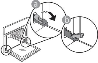
2. Uždarykite dureles. Dureles laikykite tvirtai abiem rankom – nelaikykite suėmę už rankenos.
