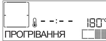
Після завершення цієї фази пролунає сигнал і на дисплеї з'явиться повідомлення про те, що духовка шафа досягла встановленої температури та необхідно "ДОДАТИ ПРОДУКТИ".
