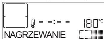
Po zakończeniu tej fazy, rozlegnie się sygnał dźwiękowy, a na wyświetlaczu pojawi się komunikat, że piekarnik osiągnął ustawioną temperaturę, wymagana, aby „DODAJ POTRAWĘ”. W tym momencie należy otworzyć drzwiczki, włożyć potrawę do piekarnika, zamknąć drzwiczki i rozpocząć pieczenie.
