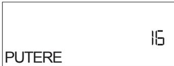
Utilizați butoanele de navigare + și - pentru a selecta 16 „Înalt” sau 13 „Scăzut” și apăsați pe ✓ pentru a confirma.
