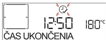
Želaný čas ukončenia prípravy jedla nastavíte stlačením **+** alebo **-**, potvrdíte ho stlačením **✓** a aktivujete funkciu. Vložte jedlo do rúry a zatvorte dverka: Funkcia sa spustí automaticky po uplynutí času vypočítaného tak, aby sa príprava jedla ukončila v čase, ktorý ste nastavili.
