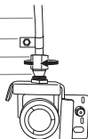
A. Tubería de cobre B. Abrazadera en "P" C. Tuerca de compresión D. Manga de compresión
