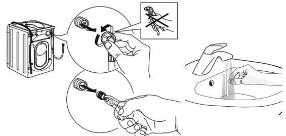
4. Vuelva a colocar el filtro. Conecte la manguera de entrada al grifo del agua y a la lavadora. No utilice herramientas para conectar la manguera de entrada. Abra el grifo del agua y compruebe que todas las conexiones estén bien apretadas.
