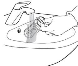
6. Coloque el filtro del agua y vuelva a instalar el panel: coloque el filtro del agua girándolo en el sentido de las agujas del reloj. Gírelo todo lo posible; el mango debe quedar en posición vertical. Para probar la estanqueidad del filtro del agua, vierta aproximadamente 1 litro de agua en el compartimento del detergente. Reinstale el plinto.
