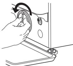
4. Desmontaje del filtro: ponga un trapo de algodón debajo del filtro del agua para que absorba los restos de agua. Retire el filtro del agua girándolo en sentido contrario a las agujas del reloj.
