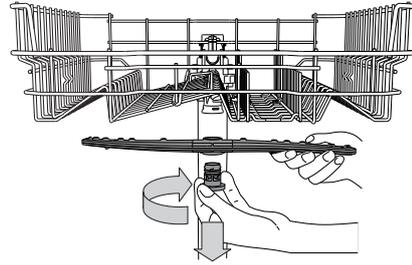
Zur Abnahme des oberen Sprüharms drehen Sie den Kunststoffring im Uhrzeigersinn ab. Der obere Sprüharm ist mit jener Seite nach oben wieder einzusetzen, die die meisten Löcher aufweist.
