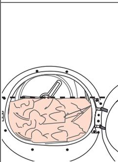
Wenn die Wäsche im Produkt die maximale Ladekapazität überschreitet, funktioniert sie möglicherweise nicht wie vorgesehen und kann Materialschäden verursachen oder das Produkt beschädigen. Befolgen Sie für jedes Programm die maximale Tragfähigkeit.
