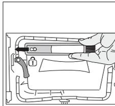
Ziehen Sie die Bürste nach links, um sie zu entfernen. Mit der Reinigungsbürste können Sie Filter, kondensierende Metalloberfläche und angesammelte Fasern an der Tür reinigen.
