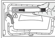
Ziehen Sie nach dem Reinigen des Filters, der Tür und des Kondensators die Bürste nach rechts und verriegeln Sie sie.
