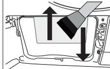
Reinigen Sie die Faser auf der Metalloberfläche des Kondensators mit einem feuchten Tuch oder der Bürste am Luftleitblech nach oben und unten. Reinigen Sie nicht von links nach rechts, da dies die Metallplatten des Kondensators beschädigen kann.
