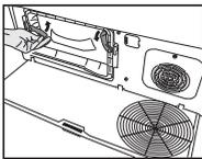
Bewegen Sie die Riegel, um den Luftleitblechdeckel zu öffnen.
