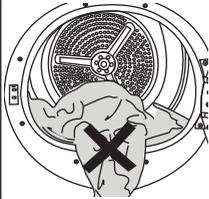
Stellen Sie sicher, dass sich keine Wäsche an der Ladeklappe eingeklemmt ist. Schließen Sie die Ladetür nicht mit Gewalt.
