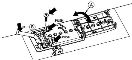
Ierīce jāpievieno barošanas avotam, izmantojot visu polu atvienošanas slēdzi, kura minimālā atstarpe starp kontaktiem ir 3 mm.
