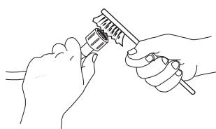
3. Ezután csavarja le kézzel a vízbevezető csövet a mosogép hátsújáról. Fogóval húzza ki a hálós szűrőt a mosogép hátsúján lévő szelepből, és óvatosan tisztítsa meg.
