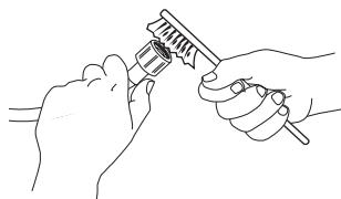
3. Skruva loss inloppsslangen på tvättmaskinens baksida för hand. Dra ut nätfiltret från ventilen på tvättmaskinens baksida med hjälp av en tång och rengör det.
