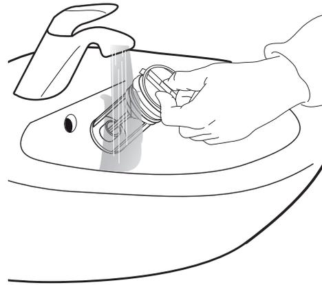
**6.** Insérez le filtre à eau et réinstallez la plinthe : Replacez le filtre à eau en le tournant dans le sens horaire. Assurez-vous de le tourner aussi loin que possible ; la poignée du filtre doit être en position verticale. Pour vérifier l'étanchéité du filtre à eau, vous pouvez verser environ 1 litre d'eau dans le distributeur de détergent. Replacez ensuite la plinthe.
