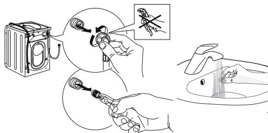
4. Remettez le filtre en maille en place. Raccordez de nouveau le tuyau d'arrivée d'eau au robinet et au lave-linge. N'utilisez pas d'outil pour raccorder le tuyau d'arrivée d'eau. Ouvrez le robinet d'eau et vérifiez que tous les raccords sont bien serrés.
