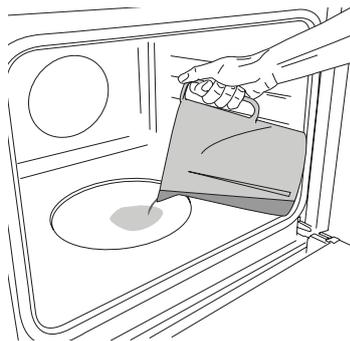
A forno freddo, riempire la cavità sul fondo del forno con la quantità d'acqua potabile indicata nella tabella di cottura. Introdurre la pietanza nel forno. Impostare e attivare la funzione steam
