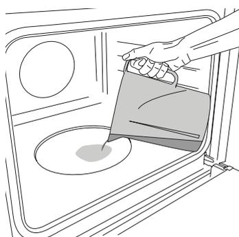
Nur wenn der Ofen kalt ist, die Aussparung des Garraums mit der in der entsprechenden Gartabelle empfohlenen Menge an Trinkwasser füllen. Stellen Sie die Speisen in den Ofen.
