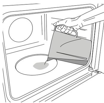
Une fois que le four est froid seulement, remplissez le gaufrage de la cavité avec la quantité d'eau potable suggérée dans le tableau de cuisson correspondant. Enfouissez le plat. Réglez et activez la fonction steam : À la fin, ouvrez la porte avec précaution et laissez la vapeur s'échapper lentement.
