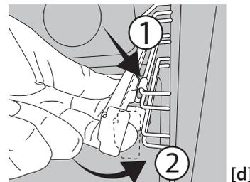
**SMONTAGGIO E RIMONTAGGIO DELLE GRIGLIE LATERALI**
