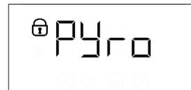
Una vez terminado el ciclo, la puerta permanece bloqueada hasta que la temperatura en el interior del horno haya vuelto a un nivel seguro. Ventile la habitación durante y después del ciclo de limpieza pirolítica.
