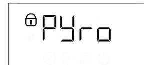
Wenn das Programm fertig ist, bleibt die Tür gesperrt, bis die Temperatur im Gerät auf ein sicheres Niveau gesunken ist. Den Raum während und nach dem Pyrolysezyklus lüften.
