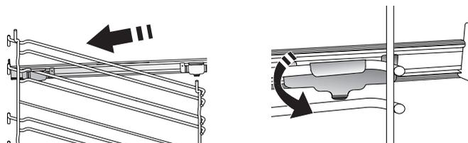
Upozornění: Posuvné drážky lze nainstalovat do kterékoli úrovně.
