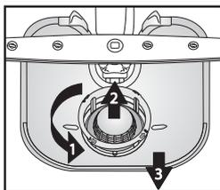
Dévissez le microfiltre (1), déposez-le (2) et retirez le filtre à tamis fin (3)...
