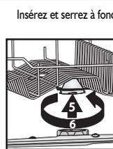
Insérez et serrez à fond les bras d'aspersion supérieur et inférieur.
