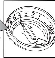
La quantité de liquide de rinçage peut être adaptée au détergent utilisé. Plus le réglage est bas, plus la quantité de liquide de rinçage utilisée sera faible (réglage d'usine : position 4). Appuyez sur le bouton pour ouvrir le couvercle B. A l'aide d'une pièce de monnaie ou d'un objet similaire, faites tourner la flèche dans la position souhaitée. Une fois le réglage de la quantité de liquide de rinçage modifié, refermez le couvercle.
